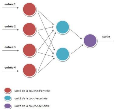
Schéma d'un réseau de neurones (profond) à couches
